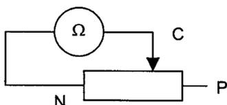
On utilise les bornes N et C du potentiomètre.
