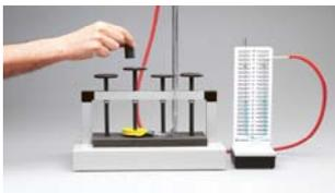
Élévation en cm = dépend de la rondelle et du poids utilisés
