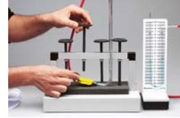
2) Placer sur le plateau la masse N°1 et noter l'élévation de l'eau dans le tube en U.
