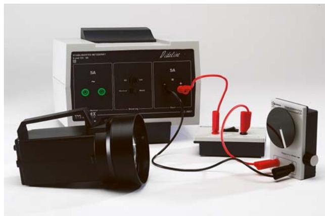
6) Fermer l'interrupteur, puis régler le bouton potentiométrique du stroboscope pour mettre en évidence l'immobilité apparente du disque stroboscopique.
