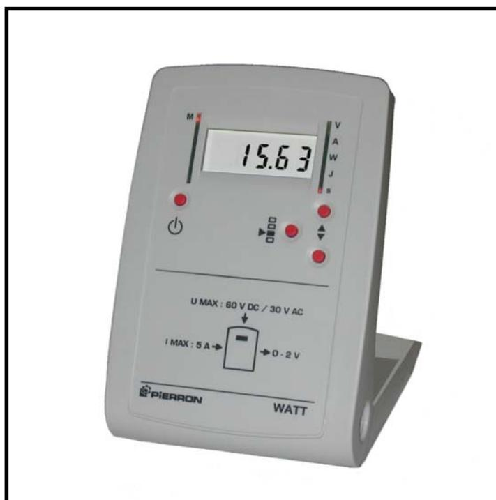
Cet appareil multifonctions vous permettra de mesurer à la fois la puissance et l'énergie électrique qui traverse l'appareil mais aussi la tension et l'intensité en un point du circuit. Ceci est réalisable quelque soit la forme des signaux, qu'ils soient continus ou alternatifs.
