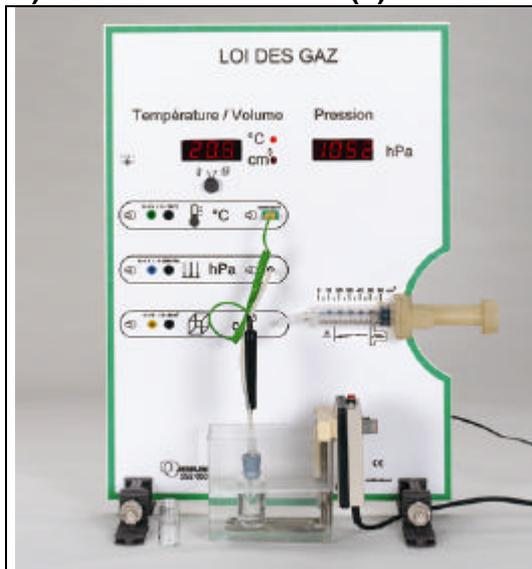
Raccorder le tuyau du capteur de pression (10) à l'enceinte Loi de Charles (30 cm<sup>3</sup> ou 60 cm<sup>3</sup>).
