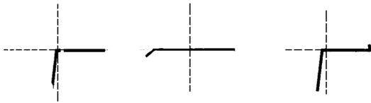
Type: **Diode normale**    **Diode haute tension**    **Diode Zener 6.8V**
