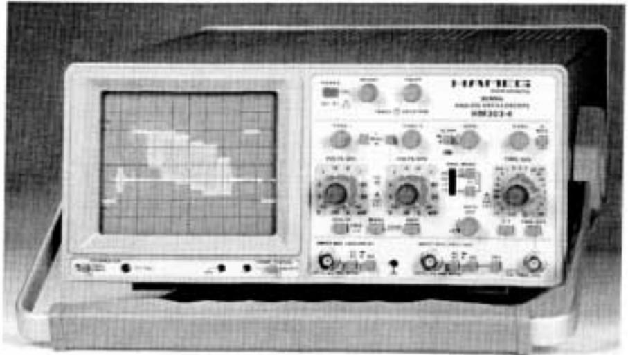
**2 voies, DC à 35MHz, 1mV/div.; indication de dépassement.**
