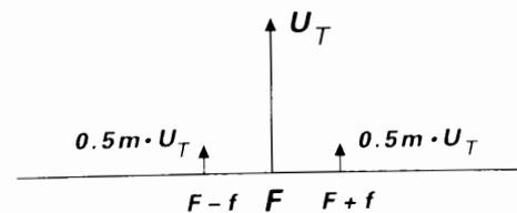
Fig. 1 Spectre de modulation d'amplitude ( $m=50\%$ ).
