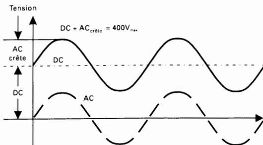
La courbe discontinue montre une tension alternative qui oscille autour de 0 Volt. Si cette tension est surchargée par une tension continue (=) l'addition de la pointe positive continue donnera la tension maximale présente (=+crête~).
