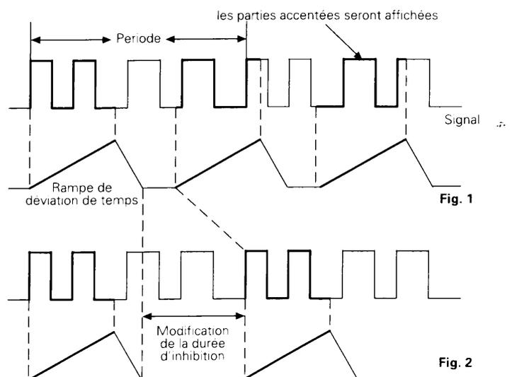
**La Fig. 1 montre le réglage du INHIBITION en position x1. Différentes parties d'une période du signal sont superposées à l'écran. La Fig. 2 présente un affichage stable.**
