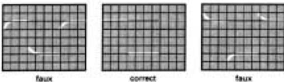
Sur l'écran on peut voir 2 trains d'onde. Il faut maintenant ajuster le trimmer de compensation, dont la position est indiquée sur la notice de la sonde. Ajuster le trimmer au moyen du tournevis isolé fourni jusqu'à ce que les crêtes supérieures du signal rectangulaire soient exactement parallèles aux lignes horizontales du graticule (voir fig. 1kHz). La hauteur du signal doit être de  $4div \pm 0,12div$  (3%). Les flancs du signal ne sont pas visibles avec ce réglage.
