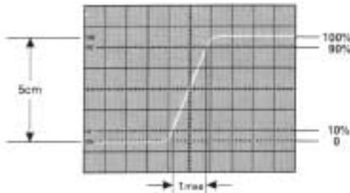
Avec une durée de balayage de  $0,2\mu\text{s/div}$  choisie sur le commutateur **TEMPS/DIV.** et la touche d'expansion x10 enfoncée l'exemple de la figure donnerait un temps de montée total mesuré de
