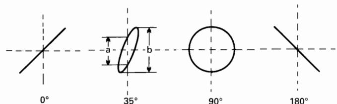
Le calcul de l'angle de phase ou du décalage de phase entre les tensions d'entrée X et Y (après mesure des distances **a** et **b** sur l'écran) est très simple avec les équations suivantes et une calculatrice de poche avec fonction sinus et est par ailleurs indépendant des amplitudes de déviation sur l'écran.
