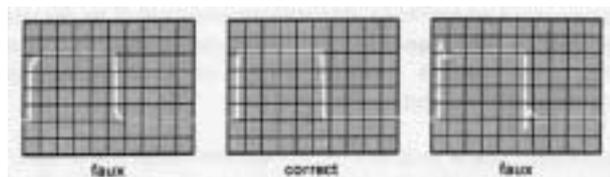
Les autres modèles de sondes ont un diamètre plus large et ne s'adaptent pas à la sortie des calibrateurs. Il n'est pas difficile de réaliser un adaptateur. Lorsque ces sondes ont un temps de montée relativement plus long, elles diminuent la bande passante. De plus, l'ajustement HF étant souvent absent, des distorsions du signal peuvent apparaître. Les réglages doivent être réalisés dans l'ordre décrit, c'est-à-dire d'abord à 1kHz puis à 1MHz, mais n'ont pas à être répétés. Les fréquences du
