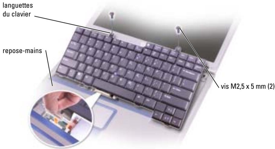
**REMARQUE :** Avant de remettre le clavier en place et pour éviter de rayer le repose-mains, assurez-vous que les languettes sont bien en place.
