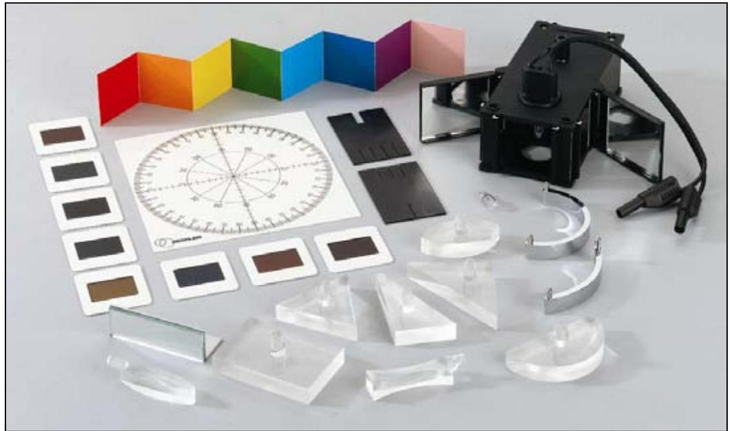
La source lumineuse est réversible, ce qui permet des utilisations diverses : en source lumineuse ponctuelle, en faisceaux parallèles et en faisceaux multiples et orientables.
