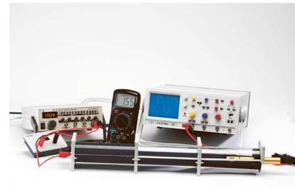
**Avec une vitesse de balayage de 1ms on a :  $T = 4 \times 1 = 4 \text{ ms} = 4 \cdot 10^{-3} \text{ s}$ .  $f = \frac{1}{0,004} = 250 \text{ Hz}$**
