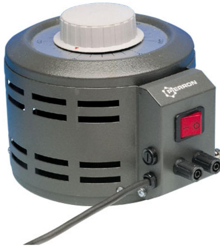
Il permet d'obtenir une tension alternative variable de 0 à 260V à partir d'un secteur 230V. Boîtier cylindrique entièrement métallique de 165mm de  $\varnothing$  et 165 mm de hauteur, avec borne de mise à la terre.
